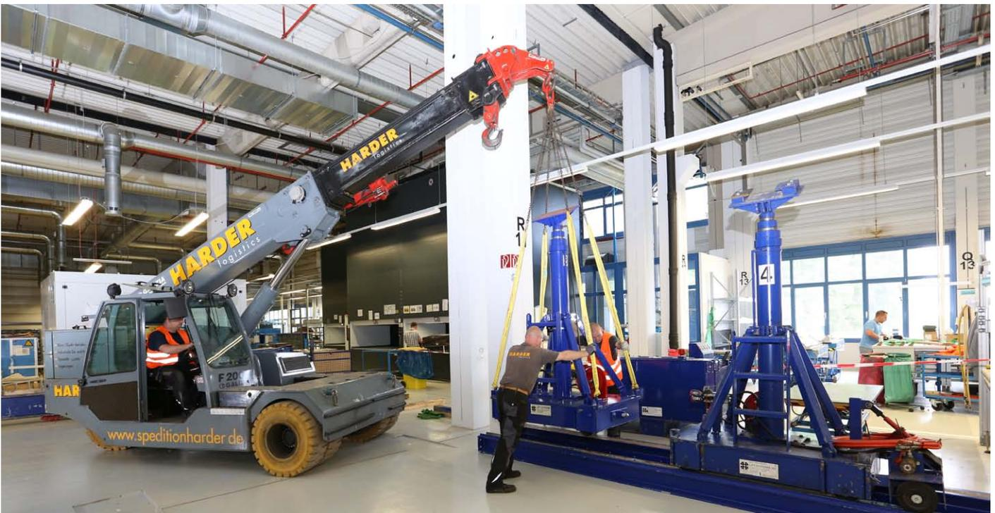
Der 20-t-Montagekran von HARDER logistics war permanent im Einsatz: für das Stellen des Hubgerüsts, die Montage von Podesten, Treppen, des Hydraulikaggregats, des Beladesystems und der Regalanlage der Pressenkombination.
